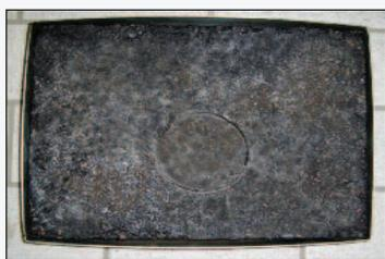
Figura 4 - La piastra confezionata con compattatore a rullo pneumatico, trattata e carotata
